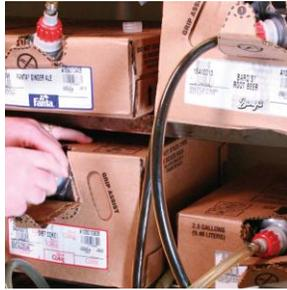
**Paso 2.** Desatornille el conector de la línea del jarabe y retire la caja vacía
