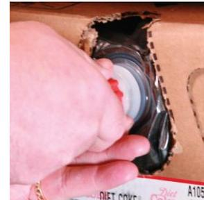
**Paso 6.** Vuelva a conectar al envase de bolsa en caja correcto. Ajuste hasta que los conectores estén completamente enganchados.
